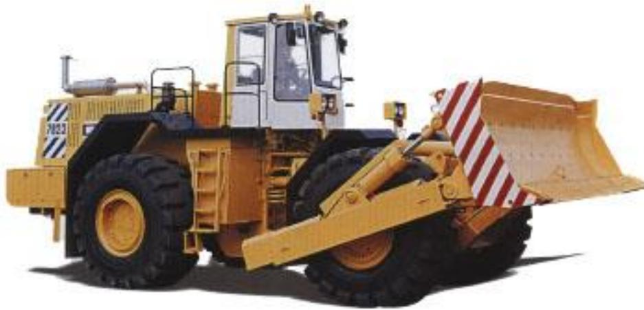
Рисунок 2 – Колесный бульдозер БелАЗ-78231
