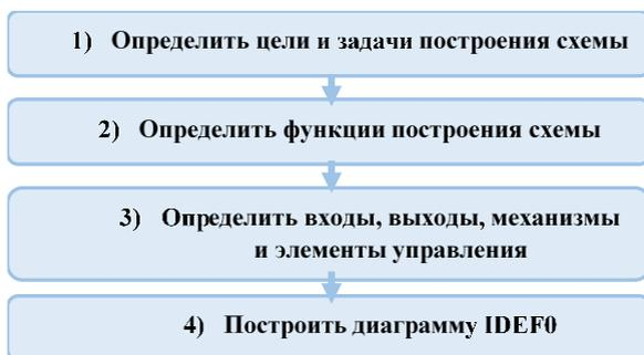
Рисунок 1 – Последовательный процесс создания IDEF0 схемы
