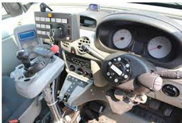
Рисунок 3 – Транспортное средство, органы управления которого были модифицированы с помощью вспомогательных устройств
