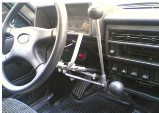
Рисунок 1 – Транспортное средство, органы управления которого были модифицированы с использованием проводных разъемов.
