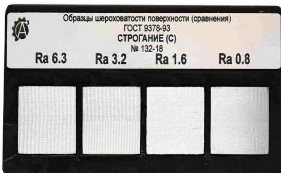
Рисунок 2 – Эталонные образцы шероховатости поверхности
