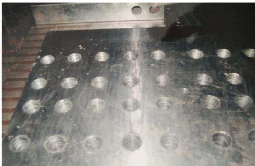
Рис. 3. Наружный вид заготовки из стали 45 на станке модели 6М13В после сверления
