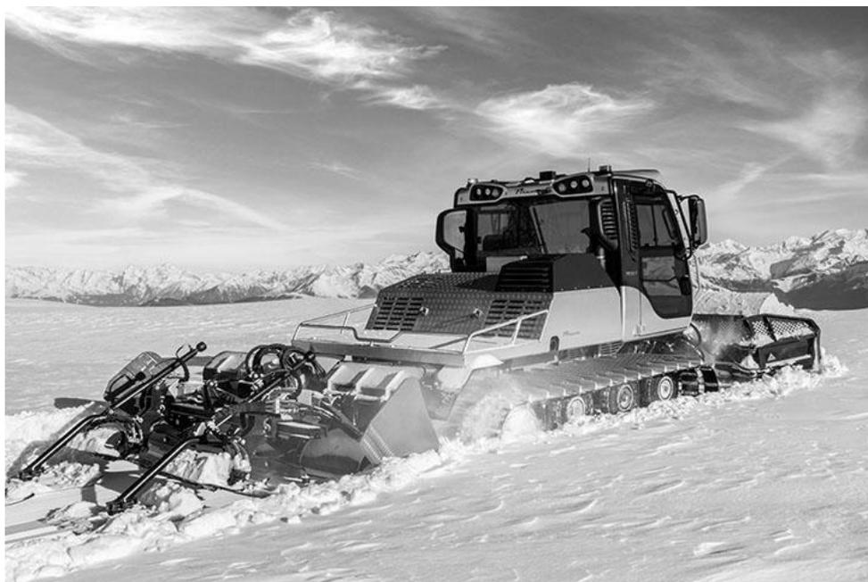
Рис. 7. PrinothHUSKY с двигателем MTU 4R 1000 OM 934
