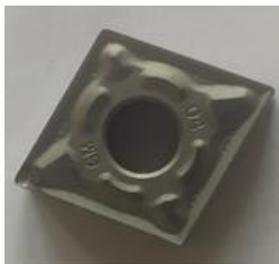
Рис. 1. Фото пластины (неполированная заготовка)
