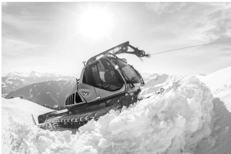
Рис. 8. PrinothLEITWOLFX с двигателем MTUR 6R 1300
