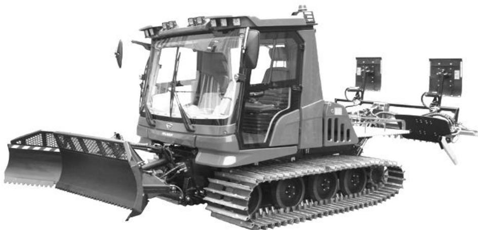
Рис. 13. Машина снегоуплотнительная «BELARUS» МСУ-108 с двигателем Д-245.35Е4 мощностью 130 кВт/177 л. с.
