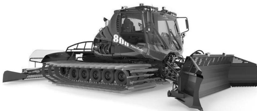
Рис. 10. PistenBully 800 с двигателем MAND38
