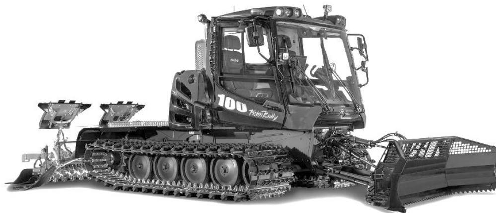
Рис. 9. PistenBully 100 с двигателем CuminsB 6.7
