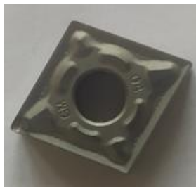
Рис. 1. Фото пластины (неполированная заготовка)
