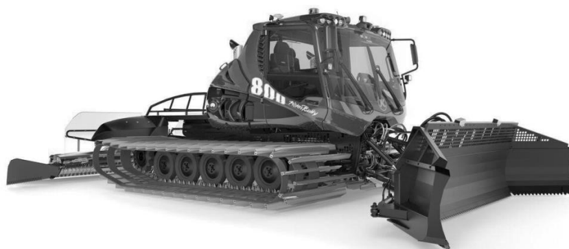
Рис. 10. PistenBully 800 с двигателем MAND38 мощностью 450 кВт/612 л. с.
