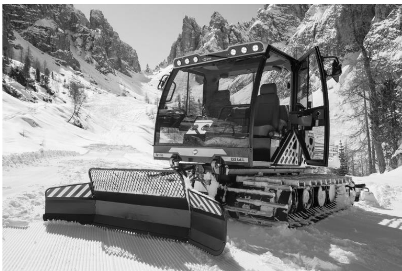
Рис. 12. Favero Lorenzo Snow Rabbit 3 с двигателем VMOTORIR754 IE5 / EU6C мощностью 84 кВт/114 л. с.
