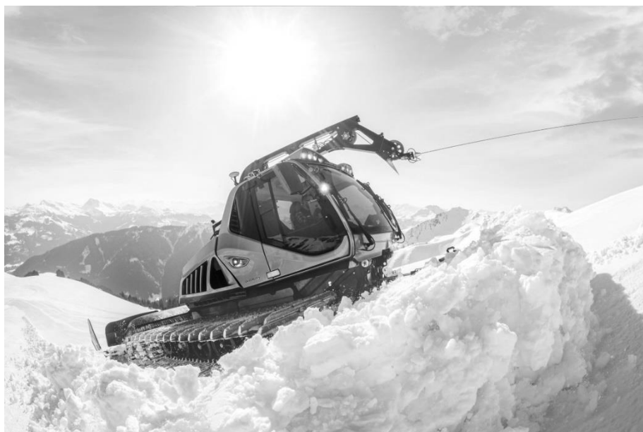
Рис. 8. PrinothLEITWOLFX с двигателем MTUR 6R 1300 390 кВт/530 л. с.
