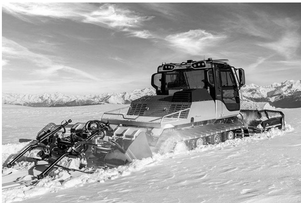
Рис. 7. PrinothHUSKY с двигателем MTU 4R 1000 OM 934 170 кВт/231 л. с.
