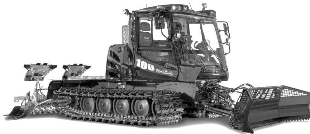
Рис. 9. PistenBully 100 с двигателем CuminsB 6.7 мощностью 188 кВт/256 л. с.
