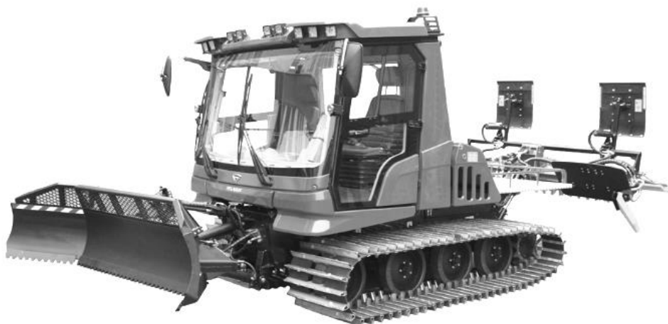
Рис. 13. Машина снегоуплотнительная «BELARUS» МСУ-108 с двигателем Д-245.35Е4 мощностью 130 кВт/177 л. с.
