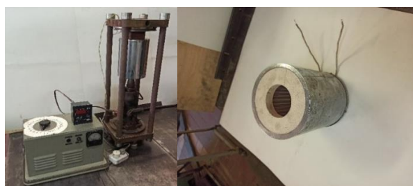
Рисунок 4. – Лабораторная установка (а) горячего статического прессования порошков, печь для нагрева технологической оснастки (б).
