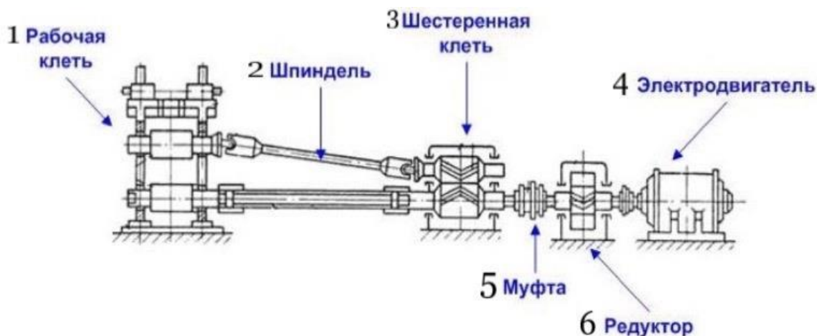
Рисунок 1 – Строение прокатного стана: 1 – рабочая клетка; 2 – шпиндель; 3 – шестеренная клетка; 4 – электродвигатель; 5 – муфта; 6 – редуктор
