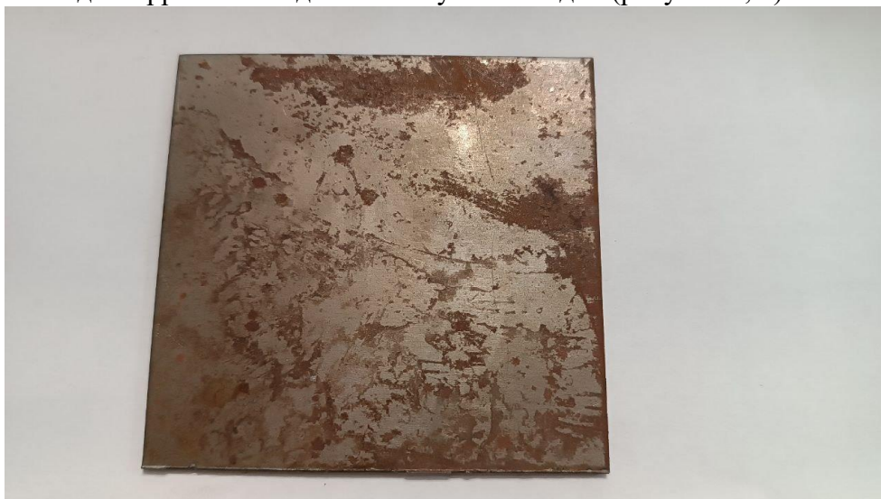
Рисунок 1 – Пластина со следами коррозии до обработки системой
