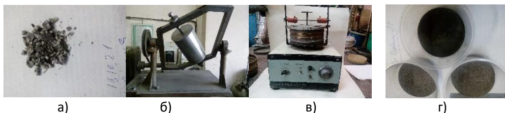
Рисунок 2 – Этапы получения порошка из титансодержащего сплава вакуумной плавки
