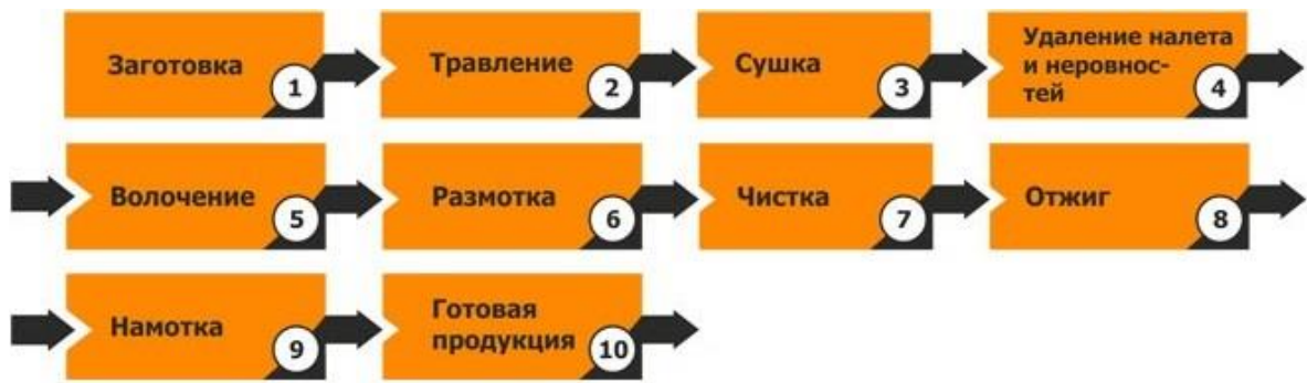
Рисунок 2 – Технологическая схема волочения проволоки из нержавеющей стали
