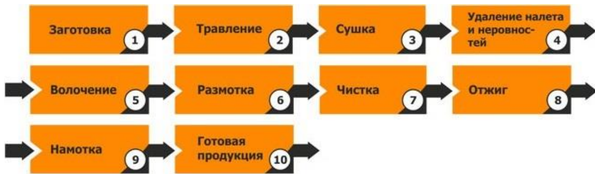
Рисунок 2 – Технологическая схема волочения проволоки из нержавеющей стали
