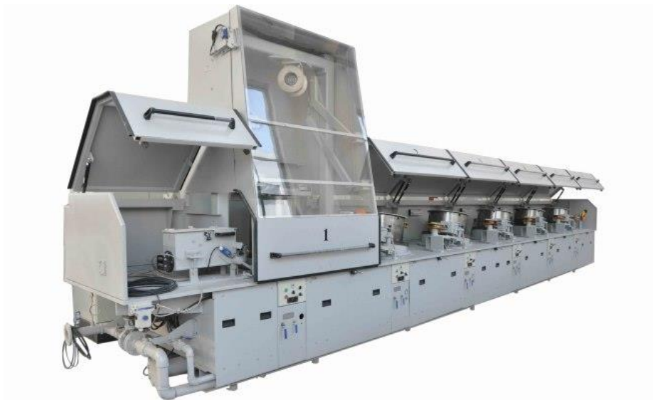
Рисунок 4 – Прямоточный волочильный стан с программным управлением
