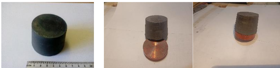
а – прессованная заготовка катода б- медный токовод; в – готовый образец катода-мишени;
