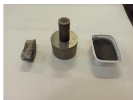
Рисунок 3 – Прессформа и исходные материалы для получения заготовок катодов.
