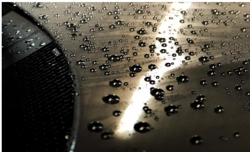
Рисунок 4 – «Эффект лотоса» на кузове автомобиля [5]
