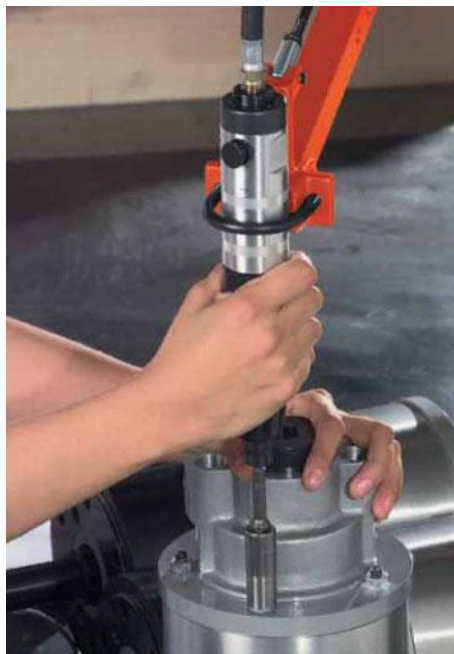
Рисунок 2.3.45 – Использование гайковерта с пневмомотором
