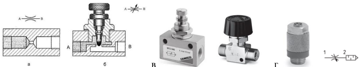
Рис. 1.4.2 Пневмодроссели (конструкция и условное графическое обозначение на схемах): а – постоянный; б – регулируемый; в – внешний вид; г – дроссель с глушителем
