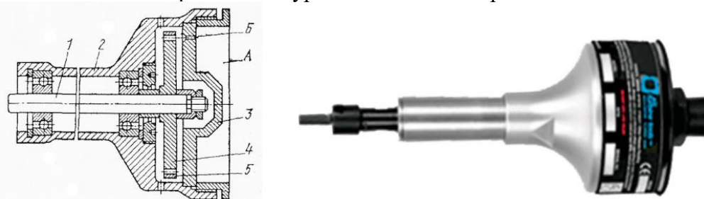
1 – выходной вал; 2 – корпус; 3 – сопловой аппарат; 4 – рабочее колесо; 5 – бандажное кольцо
