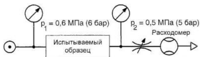
Рисунок 2.4.14 – Схема установки для определения пропускной способности пневмораспределителей
