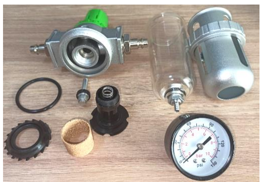
Рисунок 2.1.33 – Блок подготовки с фильтром-влагоотделителем, регулятором давления и манометром в разобранном виде
