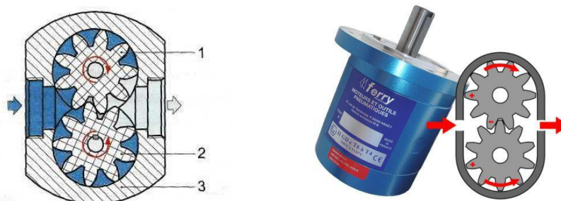
Рисунок 2.3.30 – Шестеренный пневмомотор
