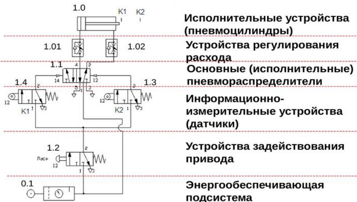
Рисунок 1.4.6 – Рекомендуемое расположение условных графических обозначений пневмоэлементов на принципиальных схемах
