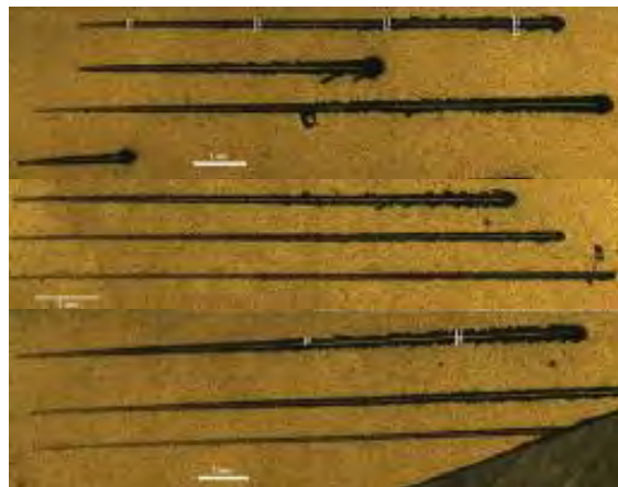
Рисунок 2 – Фотографии царапин, выполненных при помощи скретч-тестера
