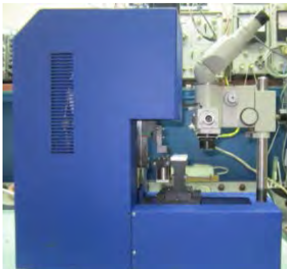
Рисунок 1 – Скретч-тестер для изучения адгезионной прочности покрытий.
