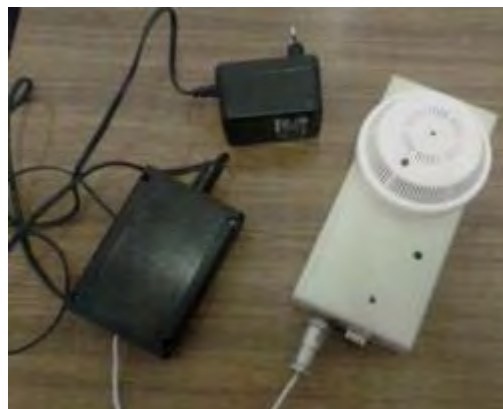
Рисунок 1 - Вид макета технического средства обнаружения пожара мультикритериального типа
