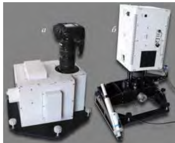
а – фотоаппарат Nikon 3D, установленный на макет ПН «СОВА-1»; б – система «ВСС», установленная на макет ПН «СОВА-2».
