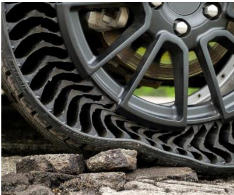
Рисунок 2 – Изменение формы безвоздушного колеса
