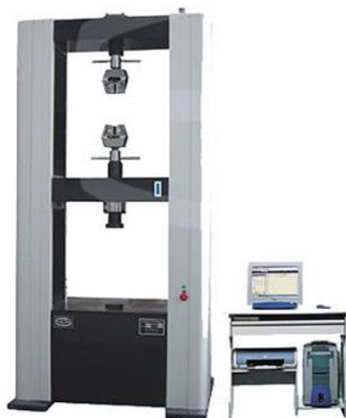
Рисунок 1 – Разрывная машина KASON WDW-100
