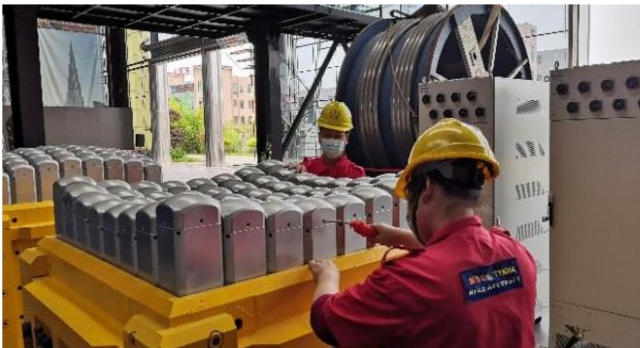
Рисунок 1 – Наладка установки для многоточечной формовки
