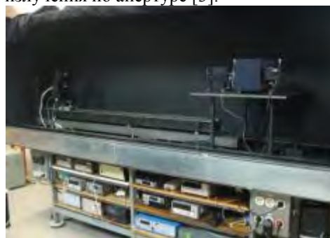
Рисунок 2 – Комплекс для измерений спектрорадиометрических характеристик излучения лазерных диодов и светодиодов
