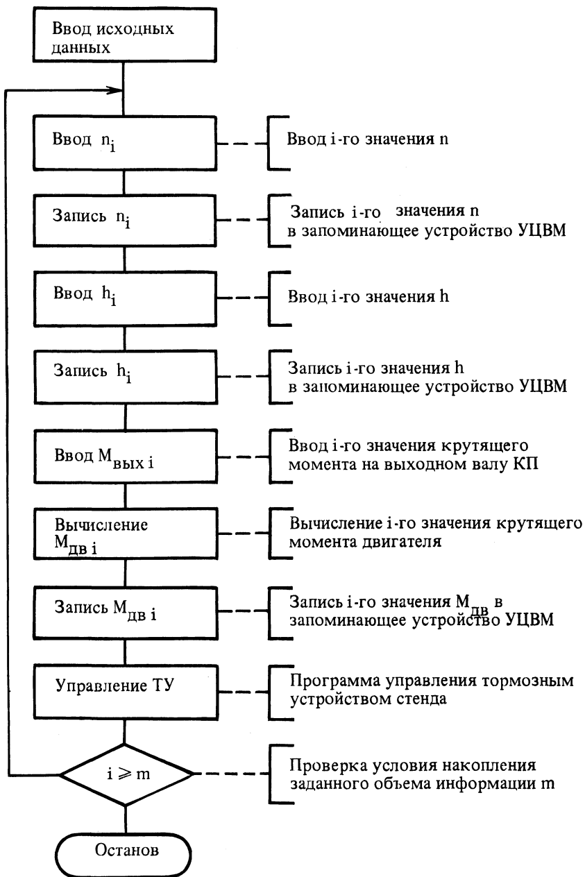
Рис. 1. Алгоритм работы управляющей цифровой вычислительной машины стэнда.
