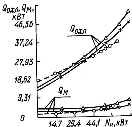
Рис. 2. Термический поток в охлаждающую жидкость и масло в зависимости от мощности дизеля:
