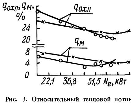
Рис. 3. Относительный тепловой поток в охлаждающую жидкость и масло в зависимости от мощности:
