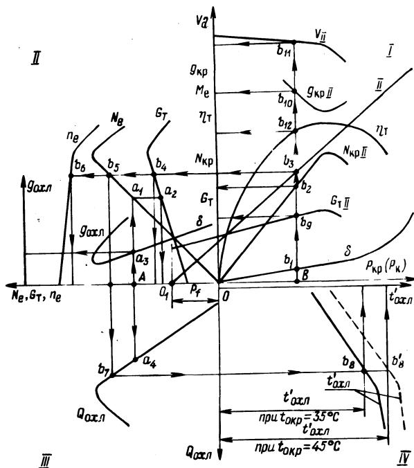
Рис. 1. Тягово-температурная характеристика трактора.
