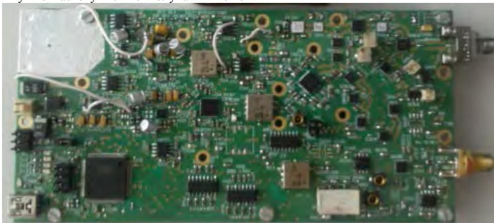
Рисунок 2 – Внешний вид синтезатора
