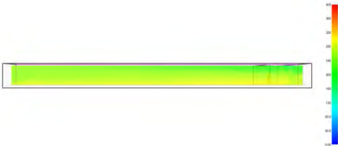
Рисунок 1 – Вид коридора на 111-й секунде пожара мощностью 500 кВт с источником на полу в комнате в начале коридора: заполнение коридора дымом (а), распределения температуры воздуха (б) и изменения давления (в) в вертикальной плоскости по продольной оси коридора
