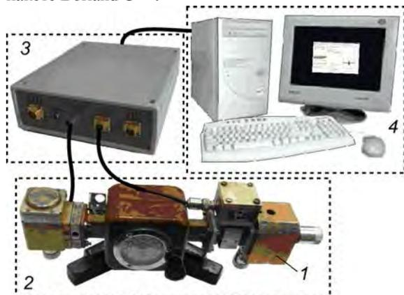
Рисунок 1 – Внешний вид (принципиальная схема) установки: 1 – рабочий СВЧ резонатор с отверстиями в виде запердельных волноводов, 2 – СВЧ тракт, 3 – специализированный волновой контроллер, 4 – персональный компьютер
