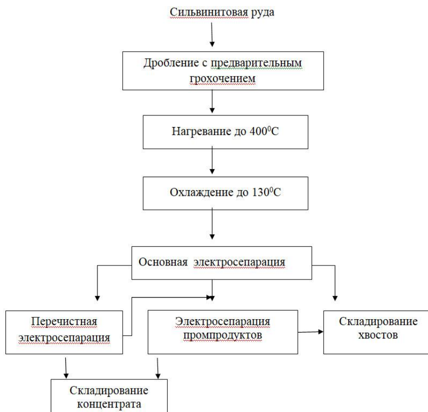
Рисунок 3. Функциональная схема производства хлористого калия электрической сепарацией
