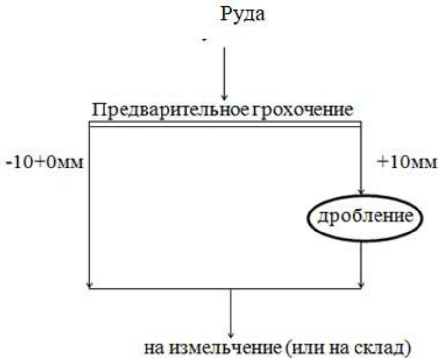
Рисунок 1.1. Принципиальная схема дробления
