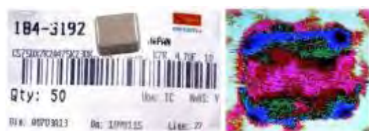
Рисунок 7 – Этикетка, внешний вид (увеличено) и лазерная фотоакустическая топограмма дефектного чип-конденсатора от японских производителей
