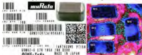
Рисунок 5 – Этикетка, внешний вид (увеличено) и групповая лазерная фотоакустическая топограмма 4 качественных чип-конденсаторов (фирма «Murata»)
