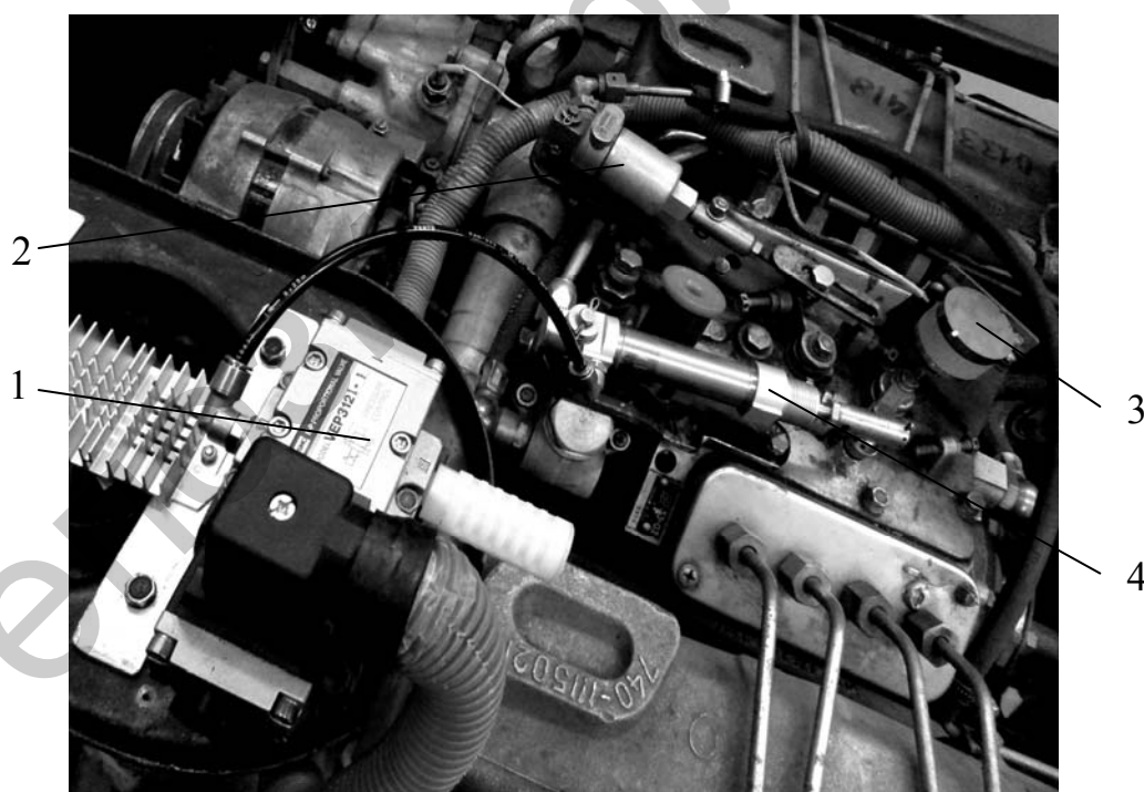
Рис. 5. Размещение пневмоцилиндра, ПЭМК и датчика МУ-615А на двигателе: 1 – пропорциональный ЭМК VER3121; 2 – пневмоцилиндр выключения подачи топлива; 3 – датчик МУ-615А перемещения рычага регулятора ТНВД; 4 – силовой пневмоцилиндр
