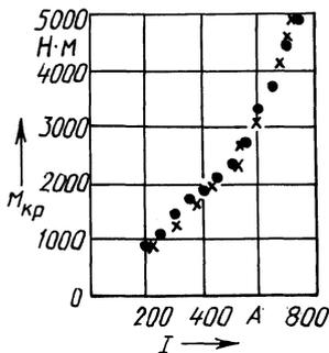
Рис. 1. Зависимость крутящего момента на входном валу редуктора мотор-колеса самосвала БелАЗ-75191 от тока в цепи якоря:
