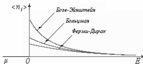
Рис. 3.7. Вид различных функций распределения частиц по энергиям в случае (E - \mu) \gg kT
