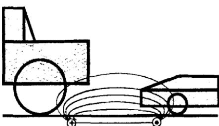
Рис.1 Проезд грузового (слева) и легкового (справа) автомобилей над индуктивной рамкой детектора транс-
