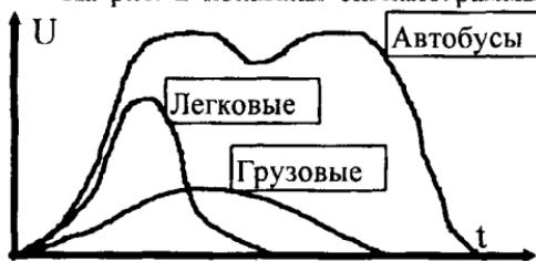
Рис.2 Сигналограммы различных транспортных средств
