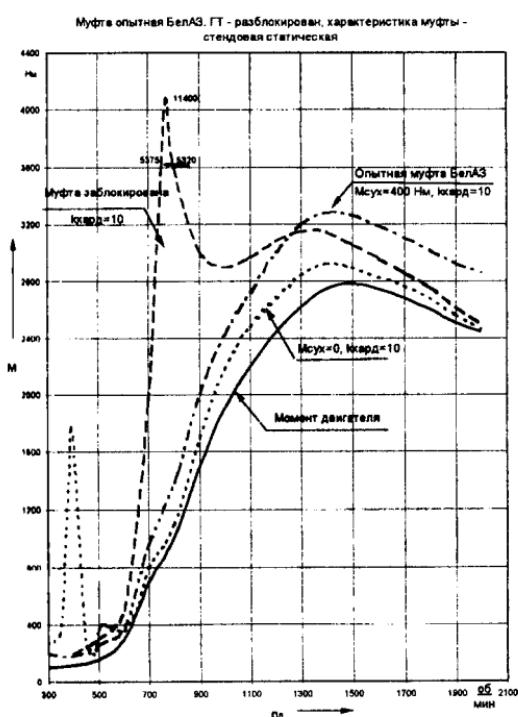
На рисунке показана зависимость максимального момента на элементах дотрансформаторного участка трансмиссии самосвала БелАЗ-7555 от частоты вращения коленчатого вала двигателя. Для сравнения на графике нанесена внешняя скоростная характеристика двигателя.
