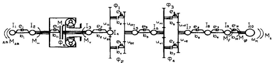
Рис.1 Схема динамической системы гидромеханической трансмиссии карьерного самосвала
