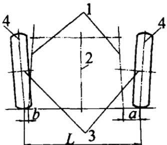
Рис. 1. Схема обеспечения неравенства плеч обката  $a$  и  $b$  направляющих колёс трактора: 1 – геометрические оси цапф (шкворней); 2 – след продольной плоскости симметрии трактора; 3 – геометрические оси вращения колёс; 4 – следы продольных плоскостей симметрии колёс;  $L$  – колея
