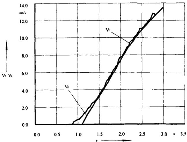
Рис. 2. Изменение действительной  $V_d$  и теоретической  $V_t$  скоростей движения троллейбуса в процессе разгона.
