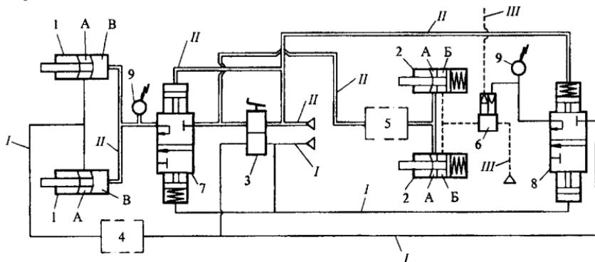
Рис.1 Принципиальная схема пневмопривода тормозов повышенной схемной надежности
