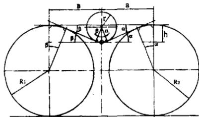
Рис. 2. Схема для расчёта длины гусеничного обвода тандем-колёсного гусеничного движителя с натяжным роликом.
