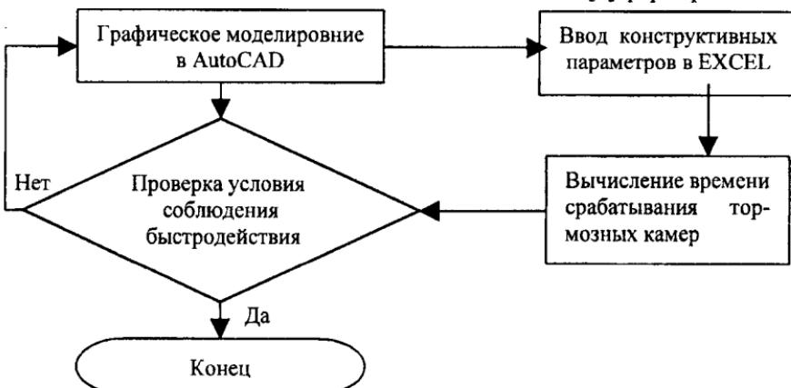
Рис. 2 Блок-схема алгоритма оптимизации пневмопривода тормозов
