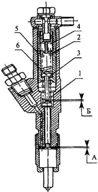
Рис.1 Двухпружинная форсунка
