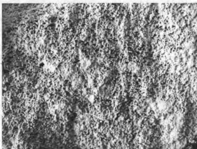
Рис. 2. Макроструктура образца цементного газобетона ( \rho = 420 \text{ кг/м}^3 ) с волокнами ВН-2
