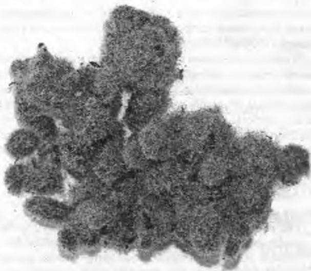
Рис. 1. Волокнистый наполнитель ВН-2 (использованная кордная ткань)
