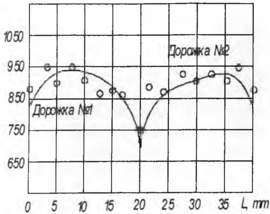
Рисунок 10 — Распределение микротвёрдости на расстоянии 1 мм от поверхности по контуру внутренней поверхности наружного кольца подшипника из стали У8А после объёмно-поверхностной закалки
