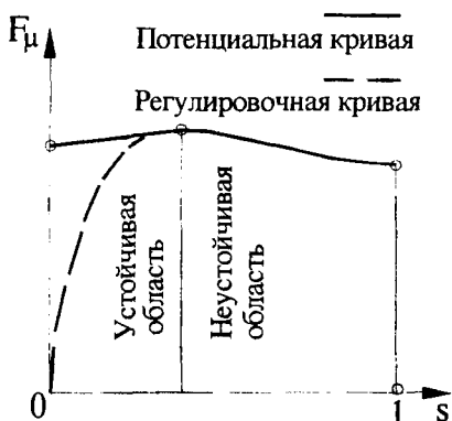
Рис. 2. Изменение потенциальной и текущей силы в контакте колеса с дорогой в зависимости от относительного проскальзывания
