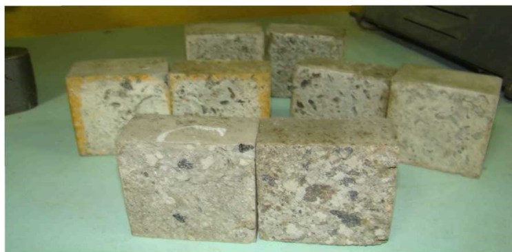
Рисунок 5.1 – Испытания при оценке прочности «старого» и «свежего» слоев бетона раскалыванием: а – до испытаний; б – после испытаний; в – расколотые образцы бетона
