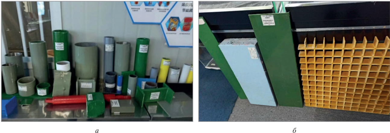
Рис. 1. Примеры фрагментов некоторых конструкций с защитными полимерными антикоррозионными покрытиями круглых (а), плоских и сложных (б) форм
