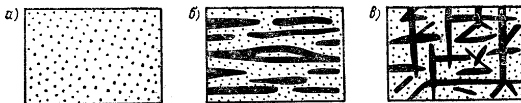
Рис.7.7. Текстура мерзлых грунтов: а) - слитная; б) - слоистая; в) – ячеистая (темные прожилки – кристаллы льда)
