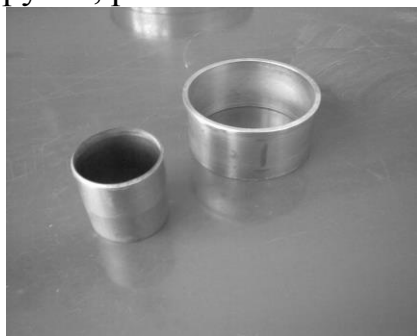
Рис.3.2. Режущие кольца для определения плотности (удельного веса) грунта в естественном состоянии
