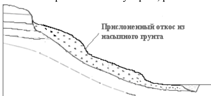
Рис.10.5. Прислоненный откос по склону оврага из насыпного грунта
