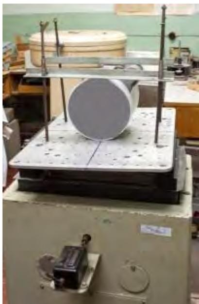
Рисунок 2 – Внешний вид ударного стенда СУ-1
