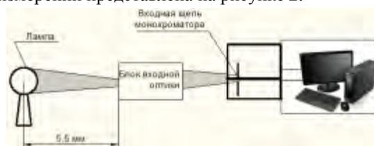
Рисунок 2 – Схема измерений СПЭО дейтериевой лампы
