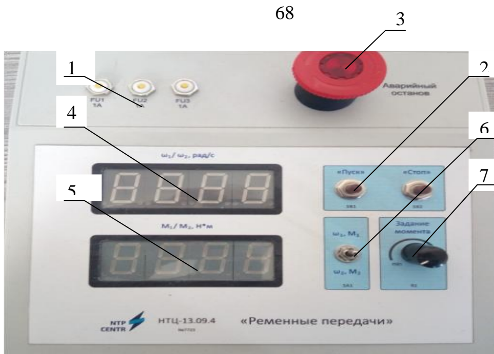
Рис. 5. Блок управления установки НТЦ – 13.09.4
