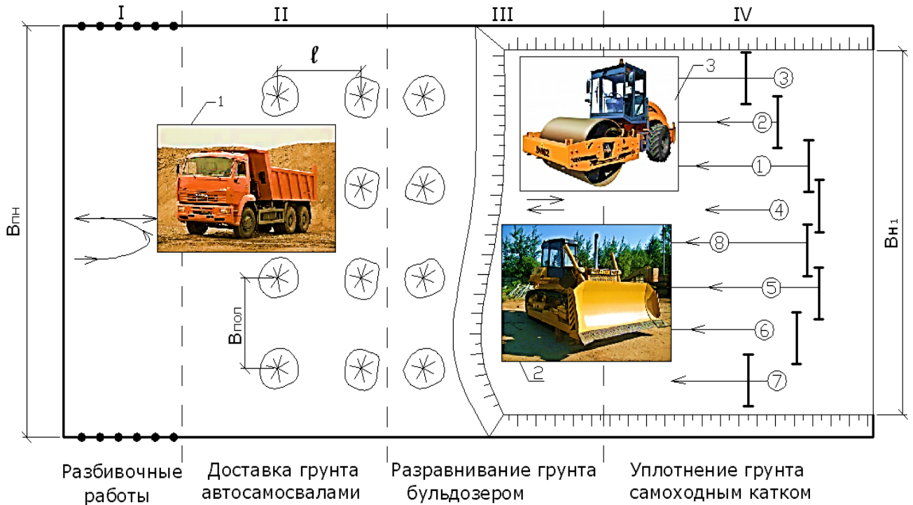
Рис. 1. Технологическая схема работы экскаваторного звена при уплотнении грунта катками по кольцевой схеме: 1 – автосамосвал, 2 – бульдозер, 3 – каток, 4 – поливомоечная машина
