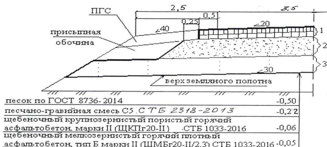
Рисунок 1 - Поперечный профиль дорожной одежды с дренирующим слоем; 1 – покрытие; 2 – основание; 3 – дренирующий слой;
