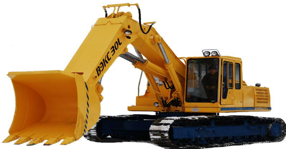
Рисунок 2- Экскаватор с оборудованием «прямая лопата»
