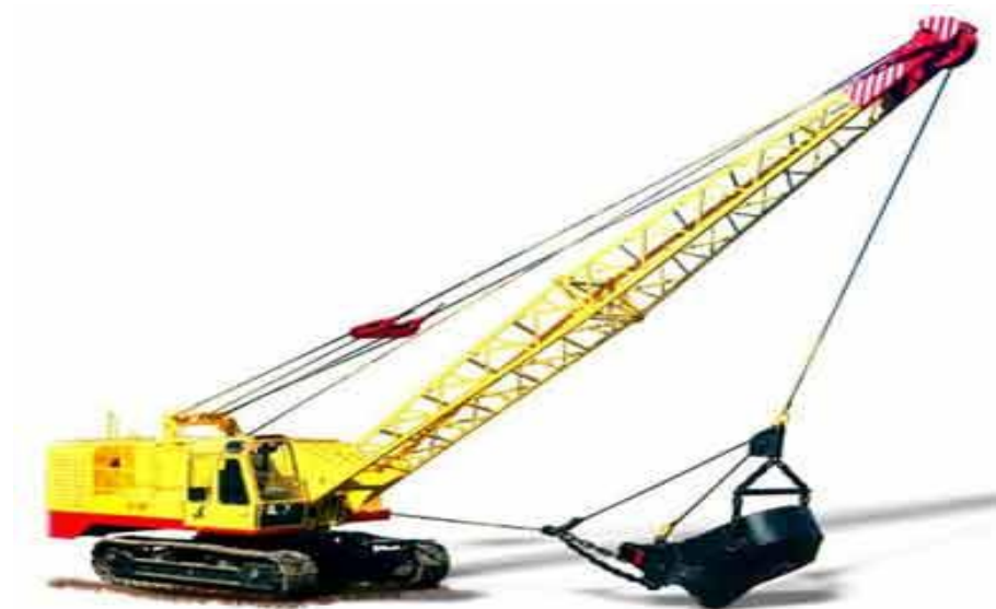
Рисунок 4 - Экскаватор с оборудованием «драглайн»
