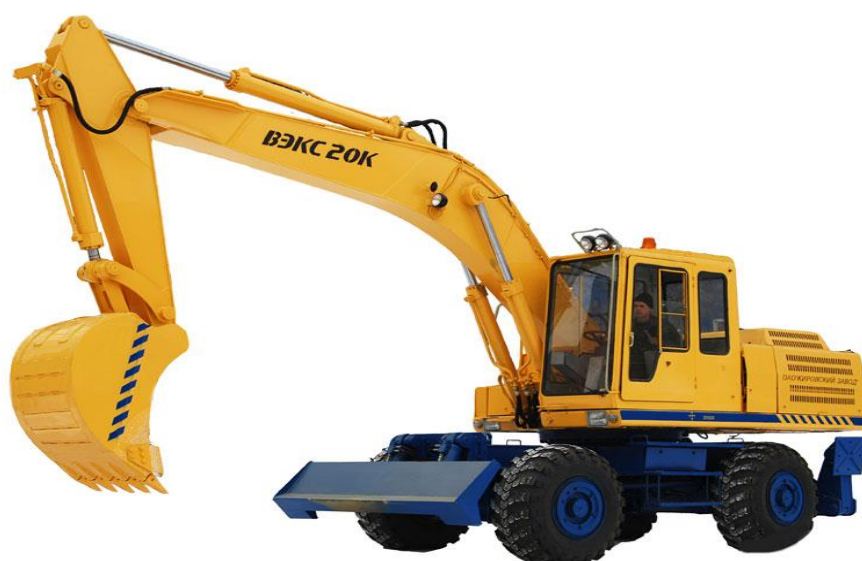
Рисунок 3 - Экскаватор с оборудованием «обратная лопата»
