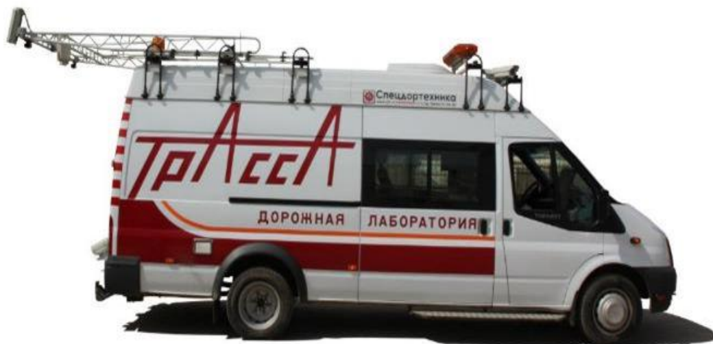
Рисунок 1 - Передвижная дорожная лаборатория «ТРАССА»
