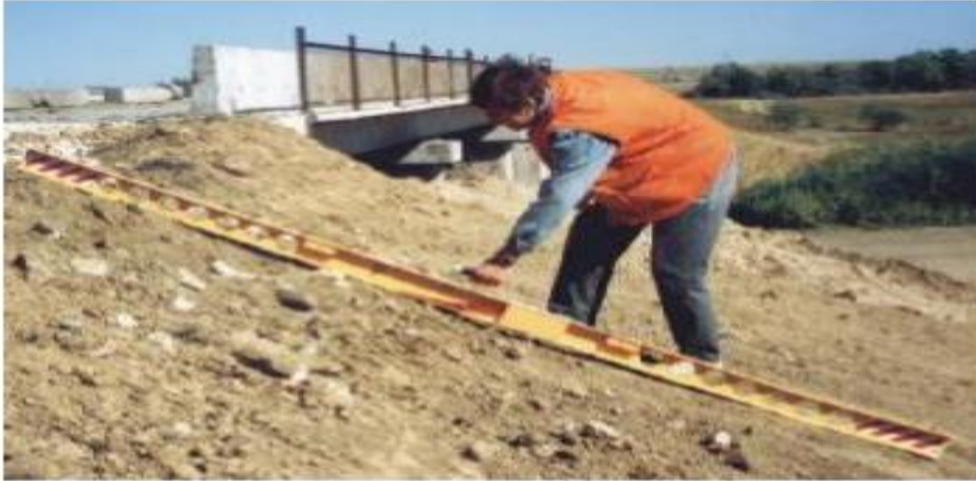
Рисунок 4 – Определение величины заложения откоса земляного полотна с помощью универсальной рейки
