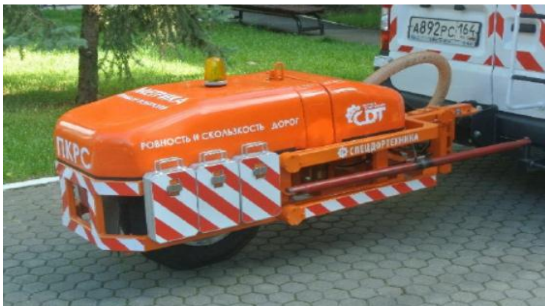
Рисунок 1 - Установка для измерения коэффициента продольного сцепления ПКРС-3.
