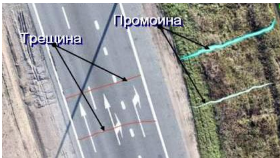
Рисунок 5 - Карта поперечных дефектов дорожного полотна
