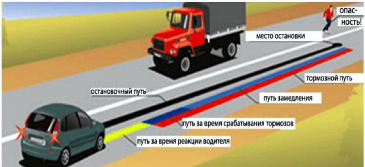
Рисунок 2— Определение тормозного пути автомобиля
