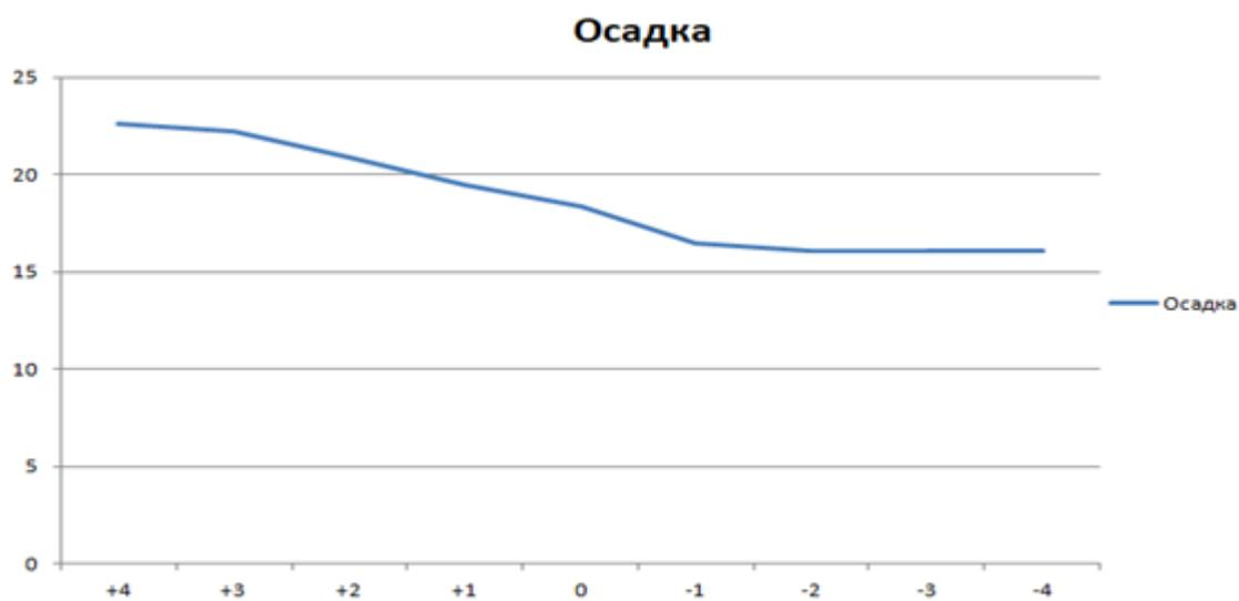
График зависимости осадки при постоянном уровне грунтовых вод от переменного загрузения:
