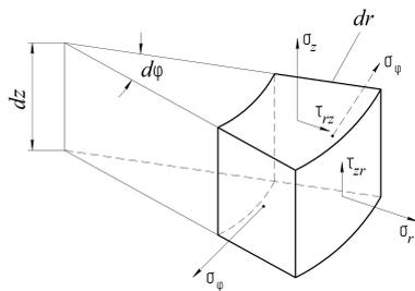
**Рисунок 2 – Элементарный объем очага деформации с компонентами тензора напряжений на боковой поверхности прессовки**
