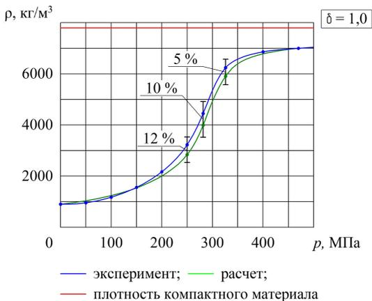
**Рисунок 6 – Зависимость плотности прессовки от давления прессования для стружки стали 45**
