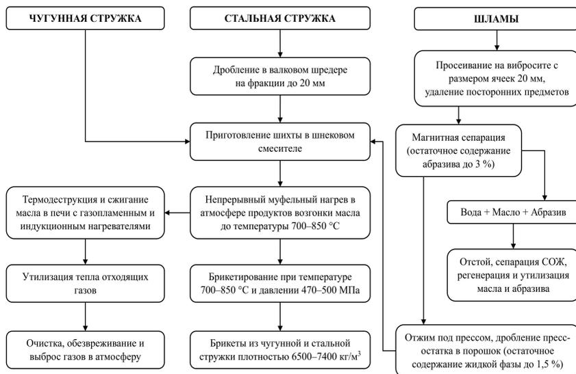
**Рисунок 8 – Технологическая схема горячего брикетирования вторичных черных металлов**
