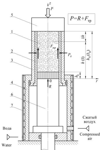
**Рисунок 1 – Технологическая схема брикетирования стружки в пресс-форме с подвижной матрицей**
