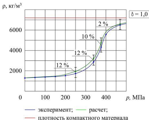
**Рисунок 7 – Зависимость плотности прессовки от давления прессования для стружки серого чугуна СЧ25**
