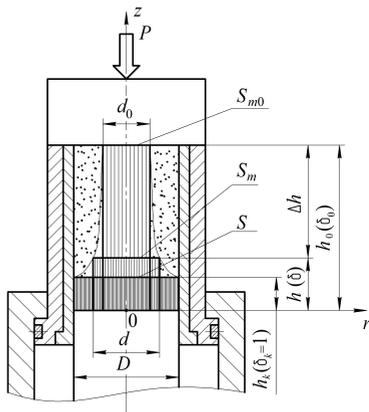
**Рисунок 3 – Схема консолидации металлических сечений пористого тела**
