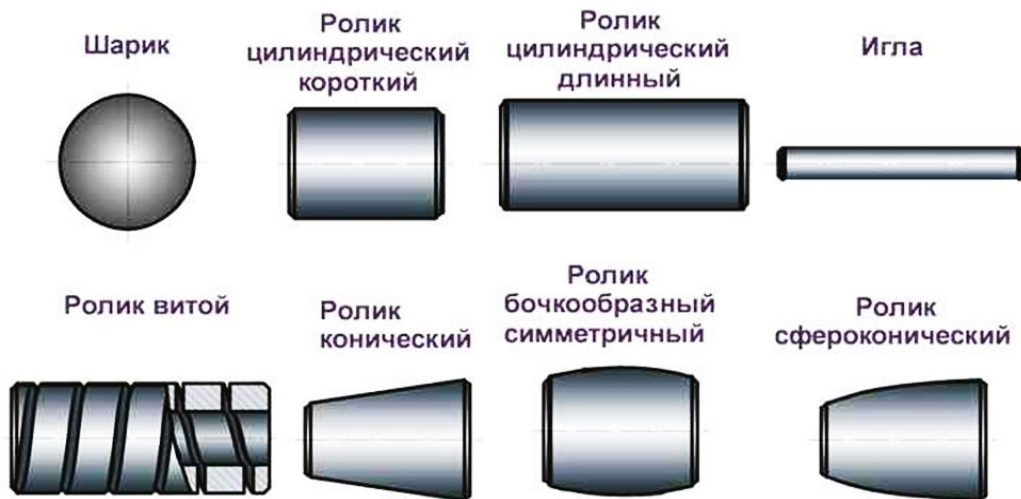
Рис. 2.2. Формы тел качения подшипников
