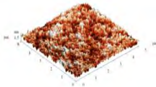
Рисунок 1 – Характерные АСМ изображения поверхности фоторезиста в режиме 3D топографии
