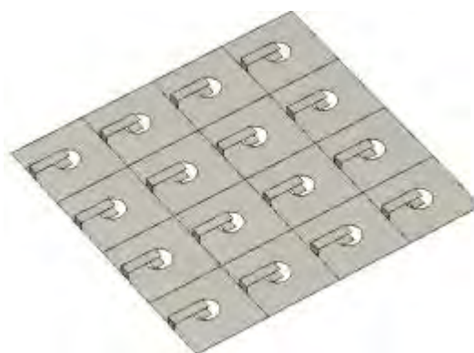
Рисунок 1 – Частотно-селективная поверхность на связанных полосковых резонаторах
