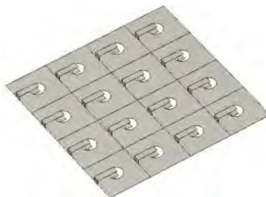
Рисунок 1 – Частотно-селективная поверхность на связанных полосковых резонаторах
