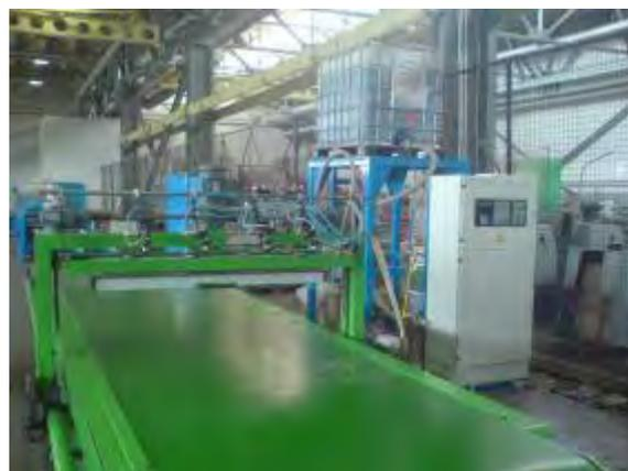
Рисунок 4 – Линия для производства сэндвич-панелей
