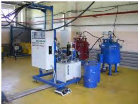
Рисунок 1 – Смесительно-дозировочные установки высокого давления
