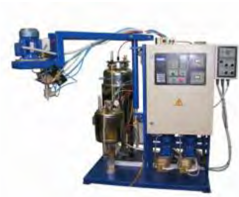
Рисунок 2 – Смесительно-дозировочная установка низкого давления
