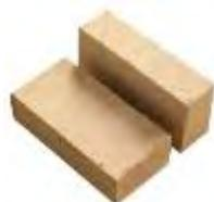
Рисунок 1– Алюмосиликатные огнеупоры на основе каолинов РБ
