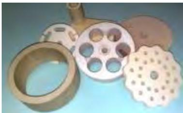
Рисунок 1– Термостойкие мулито-кордиеритовые изделия с использованием обогащенных каолинов РБ
