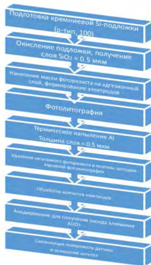
Рисунок 4 – Алгоритм технологического маршрута изготовления биосенсора емкостного типа
